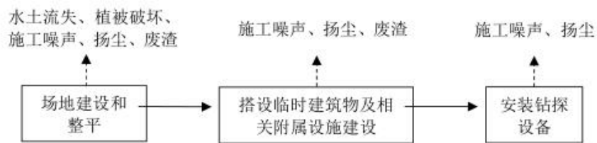
图 4-5 井场工程工艺流程图
