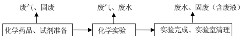
图 2-4 化学实验工艺流程及产污节点示意图
